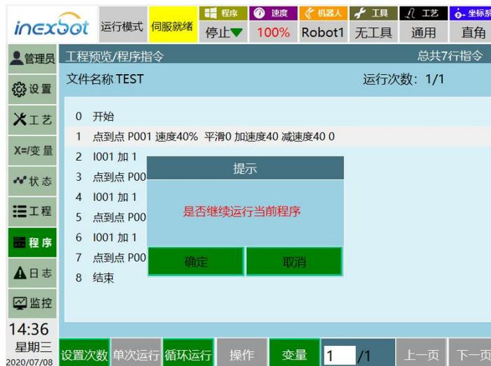
• **断点状态查看：**断点后切换到示教模式后，可以通过上电查看断点时的位置/数值变量状态。
