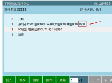
上图示例程序中，MOVJ 指令后插入 DOUT 指令；MOVJ 指令 TIME 参数填 1000ms，则运行时提前 1s 执行下一条指令，例如 MOVJ 指令会执行 3s，则 MOVJ 指令运行 2 秒执行 DOUT 并继续执行 MOVJ 到 P001。
