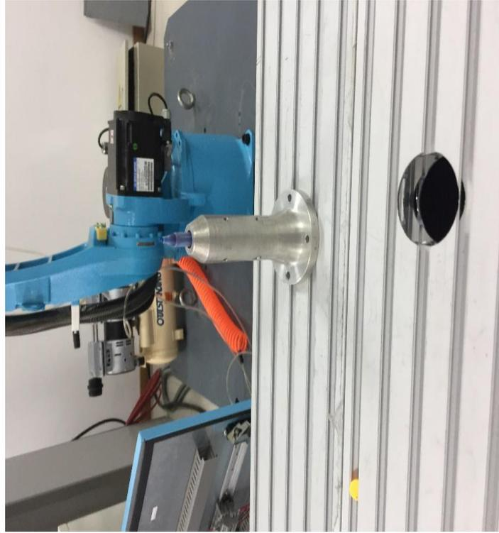
2. 将工具末端垂直且正对参考点，点击界面“TC1”所对应的【标定】按钮，如下图所示。
