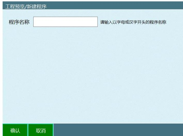
3. 点击底部的【确定】按钮，程序创建成功，并跳转入新建的程序。若想要取消新建程序，则点击【取消】按钮。
