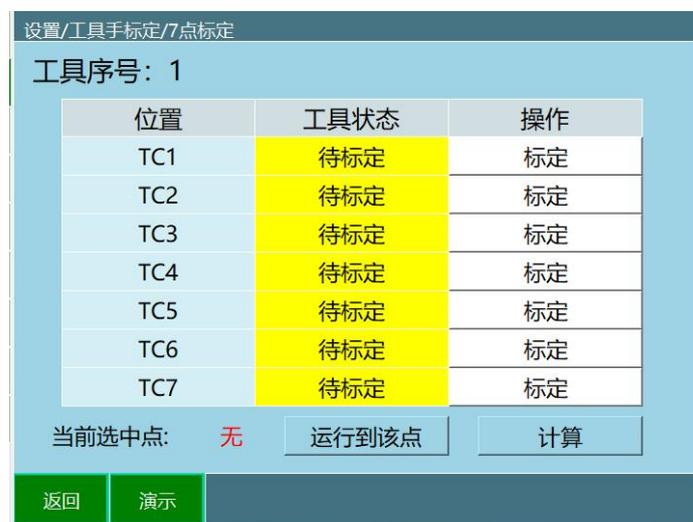
若没有工具的详细参数，可以进行 TCP 标定，自动计算出工具各项尺寸参数。具体标定步骤如下：
